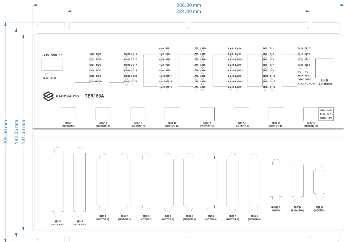
图 1.2.2 GCS160A-PCIE 控制卡端子板尺寸图
