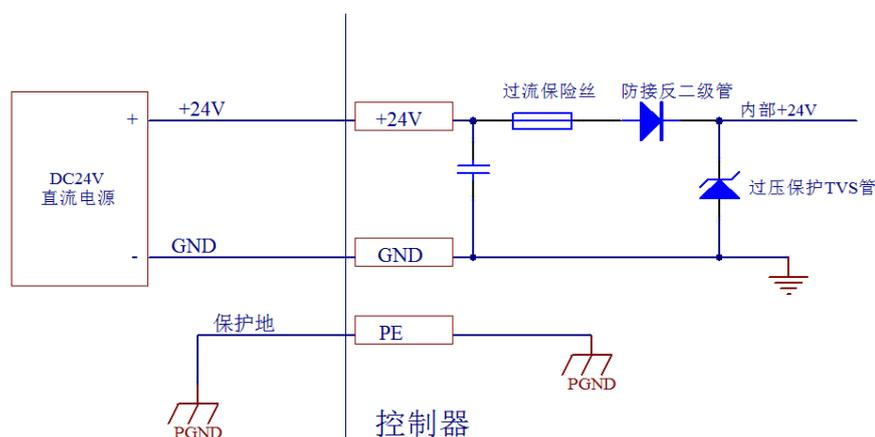
图 2.1.1 电源接口配线示意图
