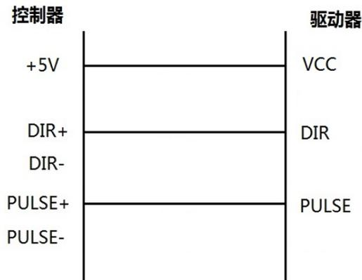
图 2.2.4 脉冲输出单端接法示意图
