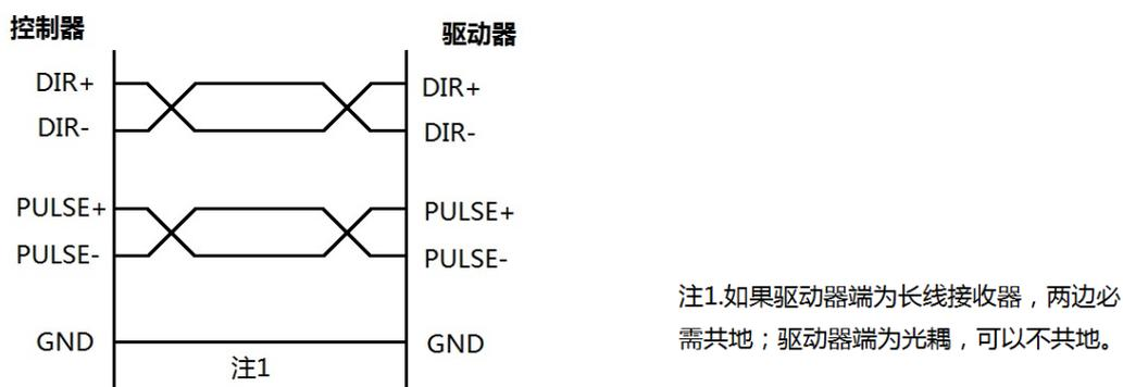
图 2.2.3 脉冲输出差分接法示意图
