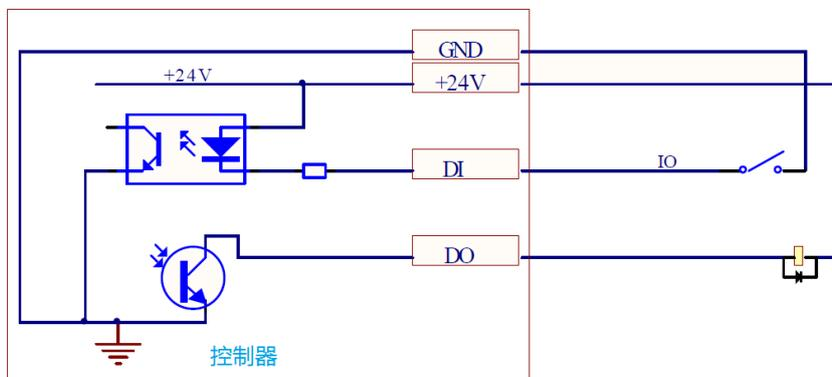
图 2.5.1 数字输入输出配线示意图
