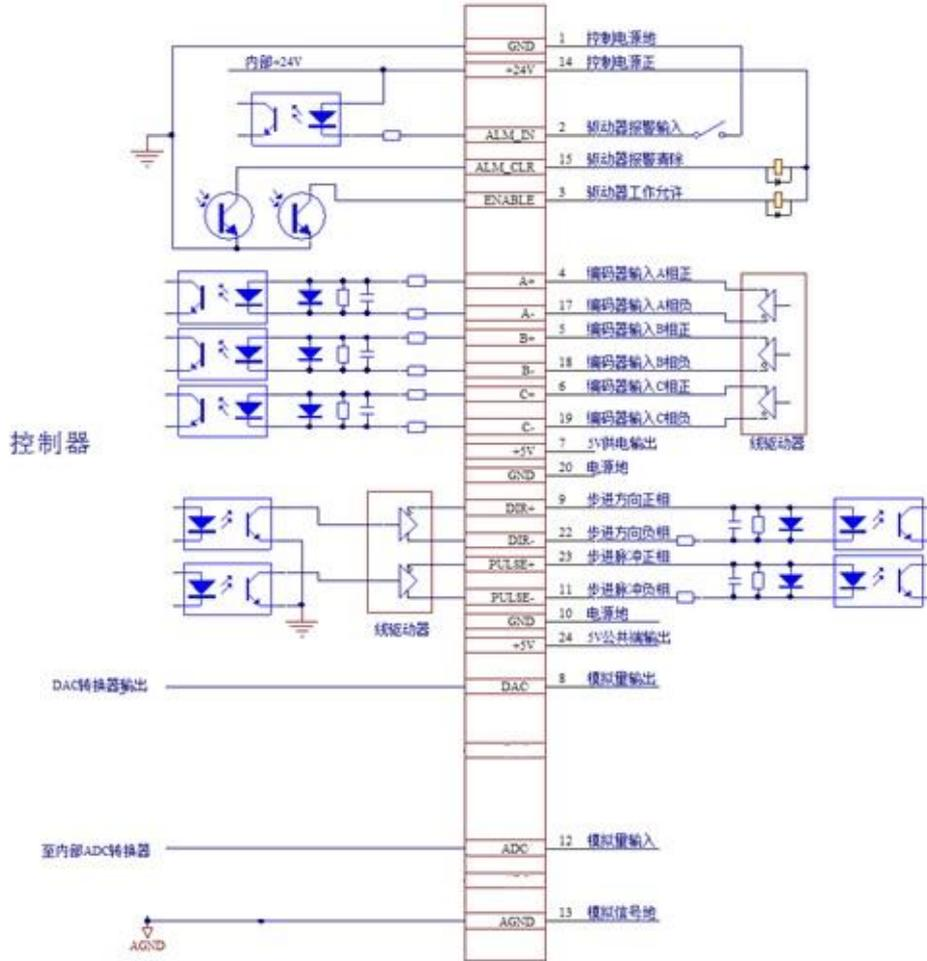
图 2.2.1 电机轴配线示意图
