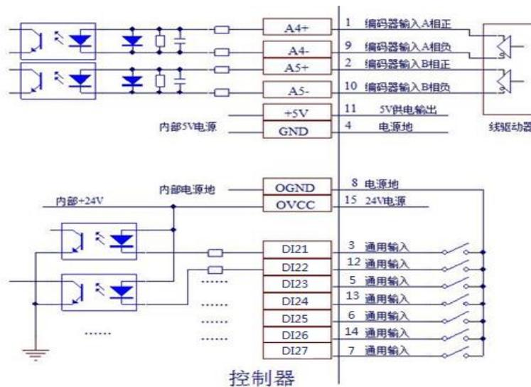
图 2.3.1 辅助编码器/手脉配线示意图
